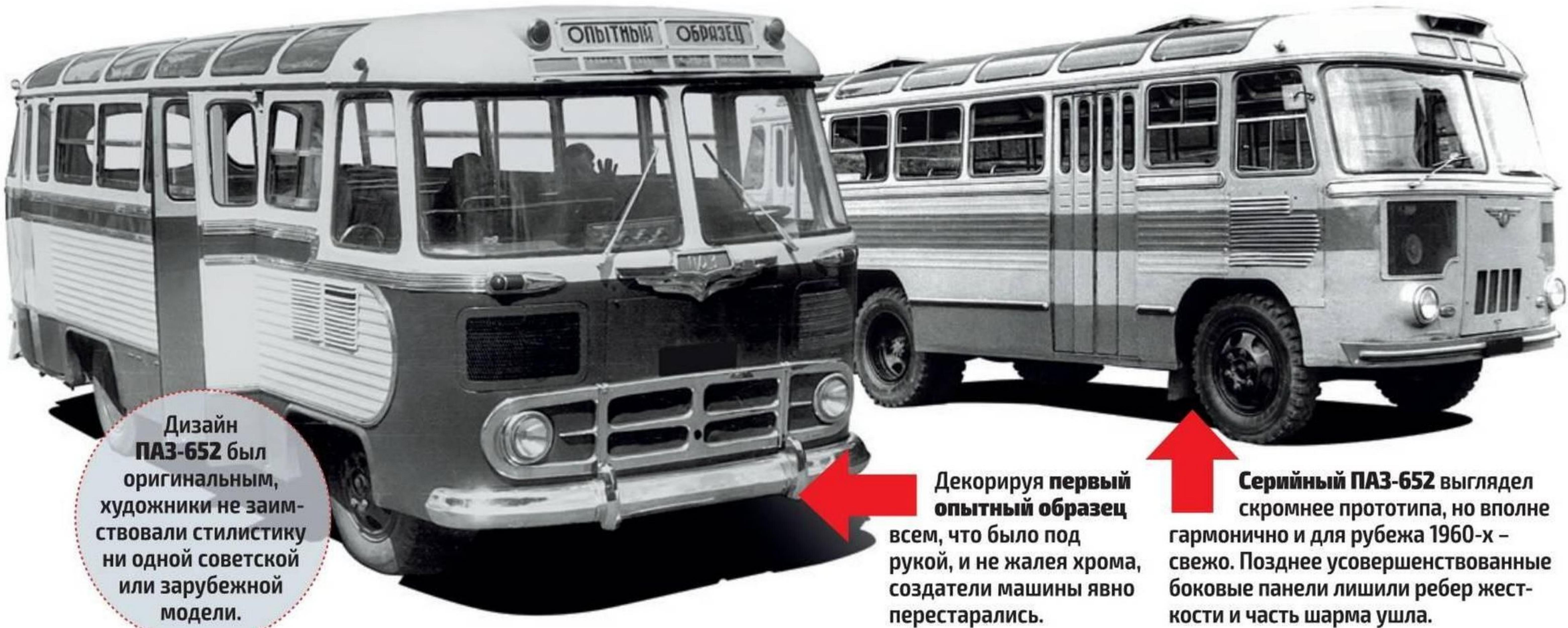
**Серийный ПАЗ-652** выглядел скромнее прототипа, но вполне гармонично и для рубежа 1960-х – свежо. Позднее усовершенствованные боковые панели лишили ребер жесткости и часть шарма ушла.
