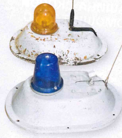
У меня есть «горбики» от РАФов из Омска и Тольятти с мигалками FER (1978 г., синяя) и Elektra (1980 г., оранжевая). Антенна спереди — от Лена-В, сзади — от Гранита-М
