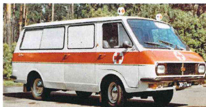
РАФ-22035 — автомобиль централизованной перевозки крови (АЦПК)
