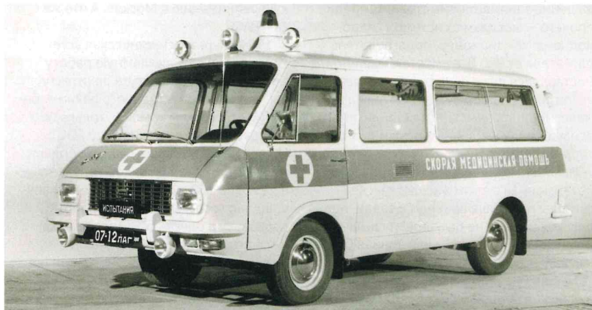
Более поздний опытный образец: клыки на бампере и такой маяк серийно не устанавливались, вентиляционная решетка на борту упразднена примерно в 1976 г.
