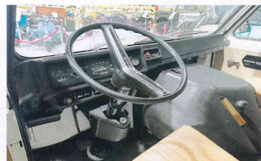
В кабине (на фото РАФ-22031) — руль от Волги и большой кожух двигателя
